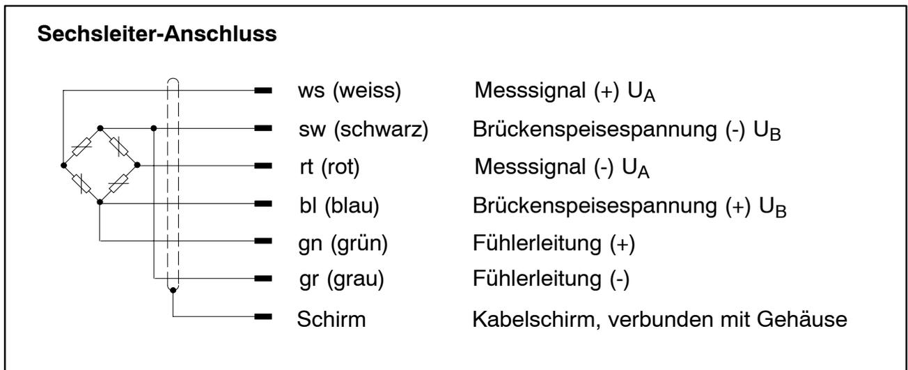
**Abb. 6.3:** Anschlussbelegung des TOP-Z4A
