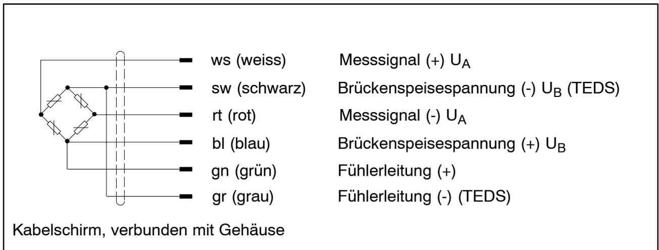
**Abb. 6.2:** Anschlussbelegung für Anschlußkabel KAB139A-6 mit freien Enden
