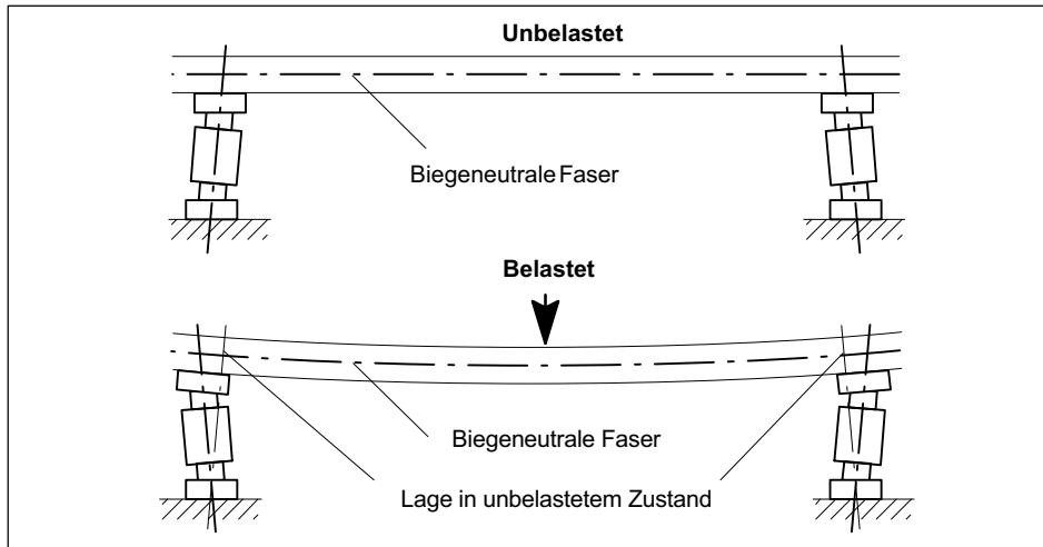
Alternativ ist auch ein einseitiges Unterlegen von dünnen Blechen (ca. 0,5 mm dick) unter die Druckstücke an den angegebenen Stellen möglich.
