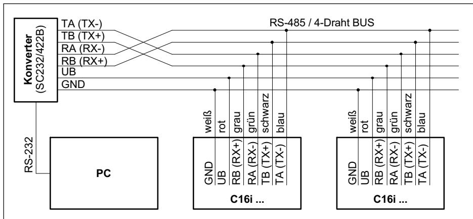
Abb. 5.1 Kabelbelegung
