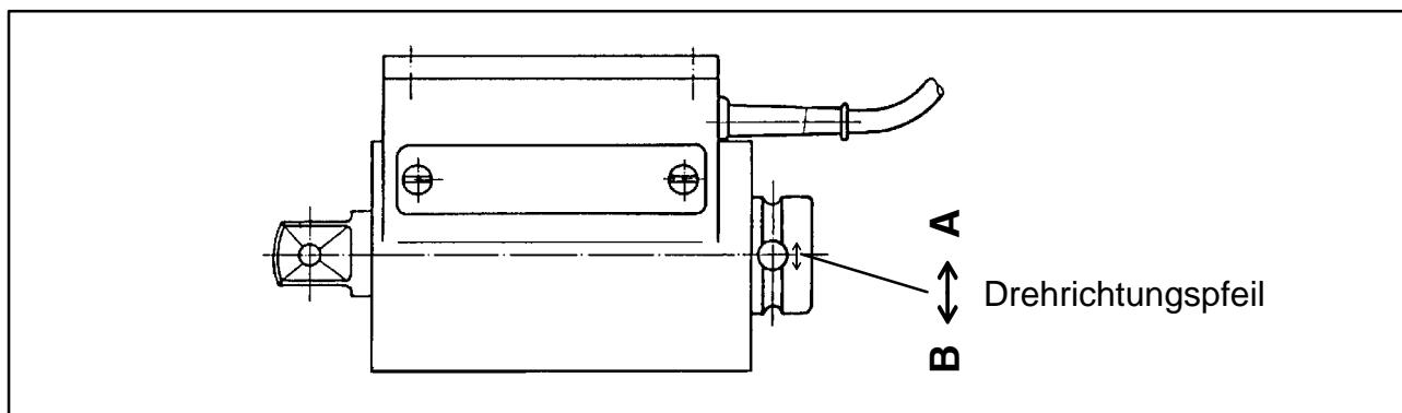
**Abb. 5.2:** Drehrichtungspfeil
