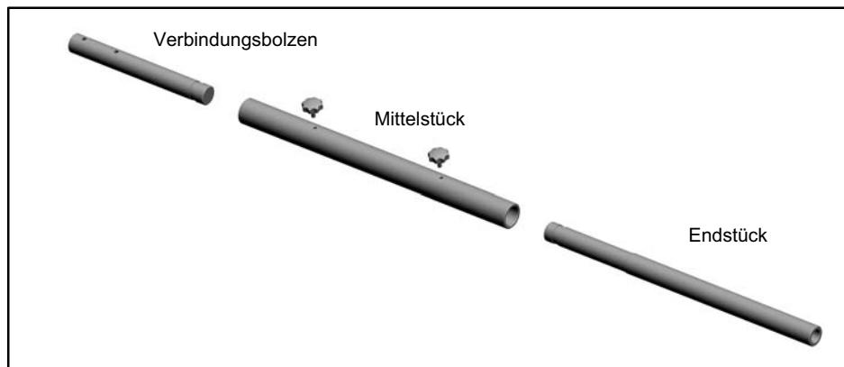
Abb. 5.5 Dreiteiliger Hebel (500 N·m, 1 kN·m)
