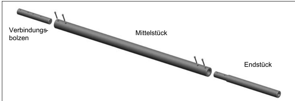
Abb. 5.6 Dreiteiliger Hebel (3 kN · m)
