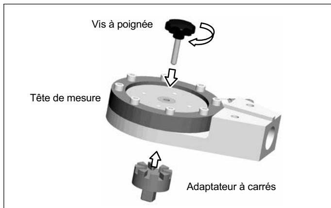
Fig. 5.2 Montage de l'adaptateur à carrés sur la tête de mesure
