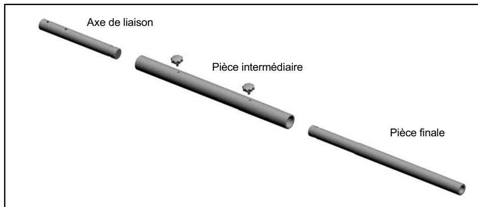
Fig. 5.5    Levier en trois pièces (500 N·m, 1 kN·m)
