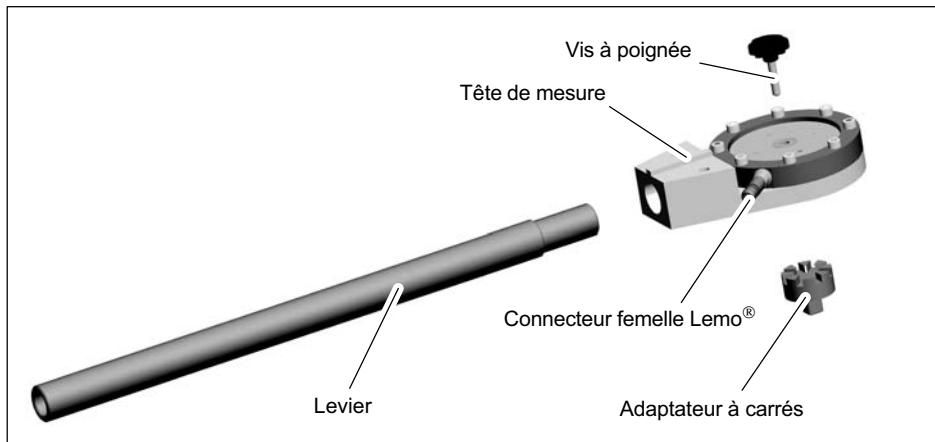
Fig. 4.1 Structure mécanique
