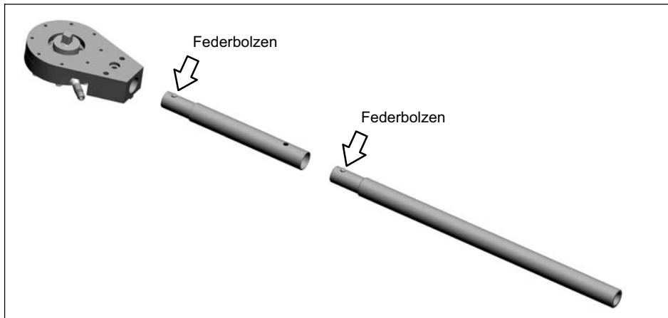
Abb. 5.4 Zweiteiliger Hebel
