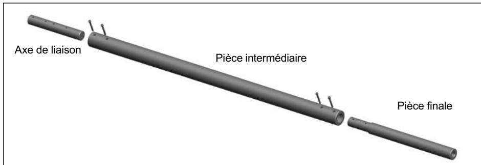
Fig. 5.6 Levier en trois pièces (3 kN · m)
