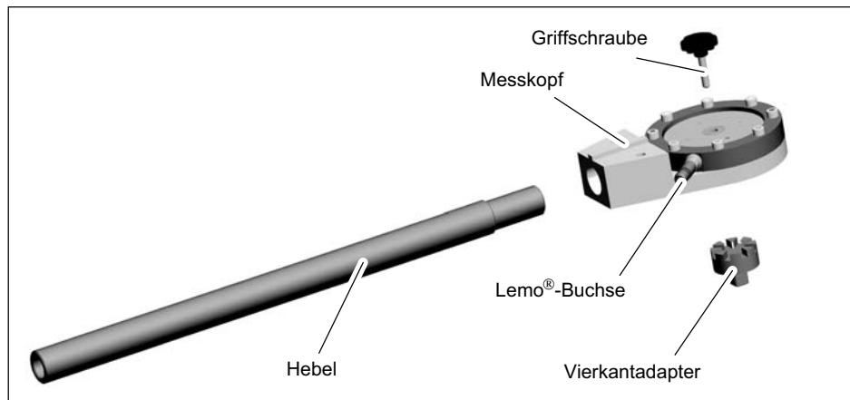
Abb. 4.1 Mechanischer Aufbau
