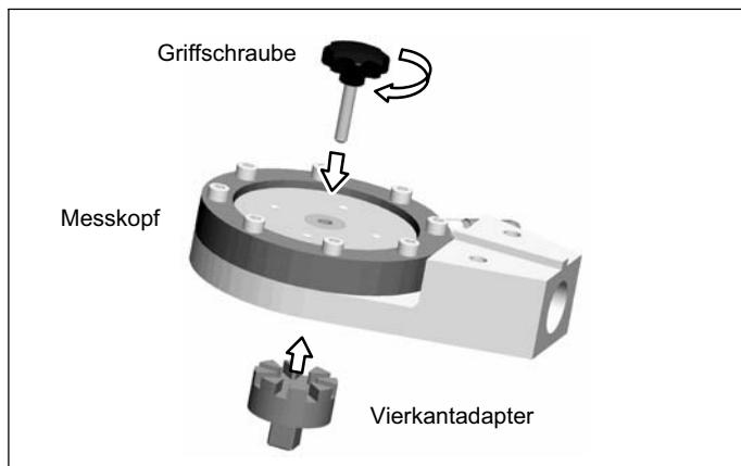
Abb. 5.2 Vierkantadapter am Messkopf montieren
