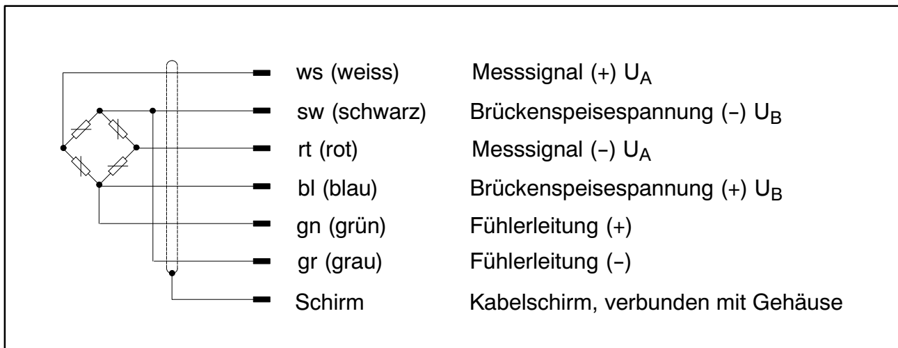
Abb. 6.1: Anschlussbelegung der U5 mit freien Enden
