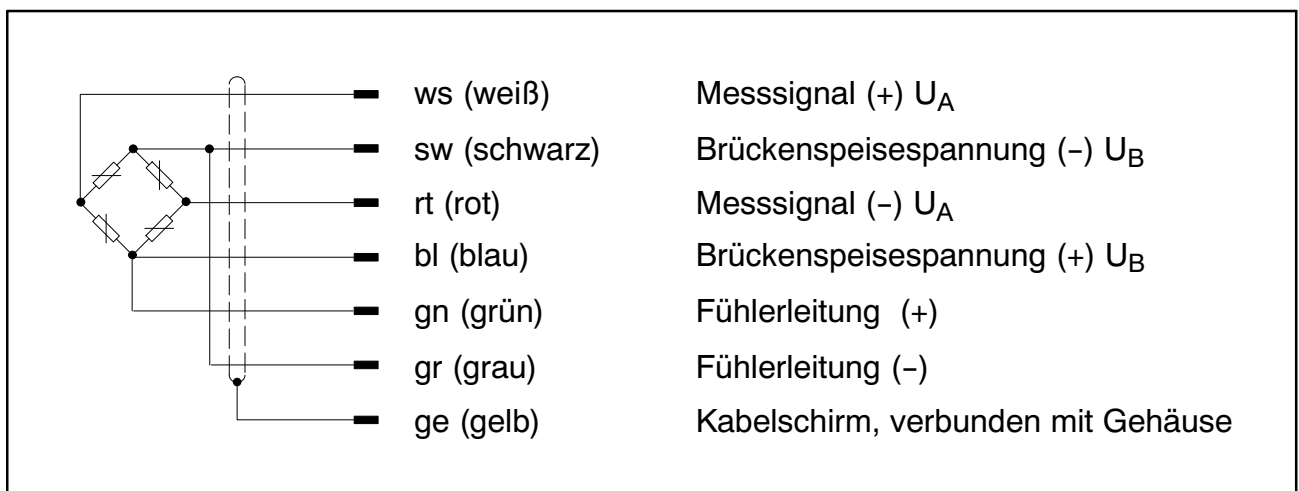
Abb. 5.2: Anschlussbelegung der U2B
