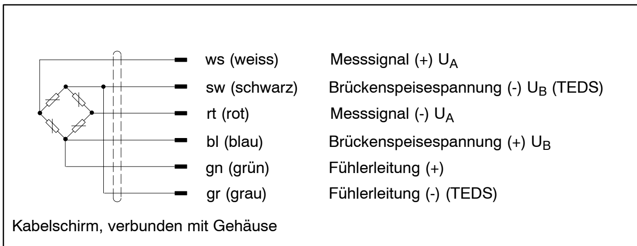
Abb. 6.2: Anschlussbelegung für Anschlußkabel KAB139A-6 mit freien Enden
