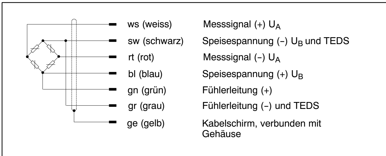
Abb. 6.1: Anschlussbelegung des U93 (Sechisleiter-Technik)
