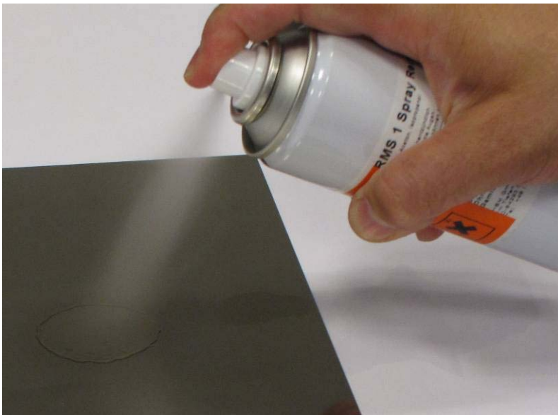
Abb. 1.1: Besprühen der Messstelle mit 1-RMS-SPRAY
