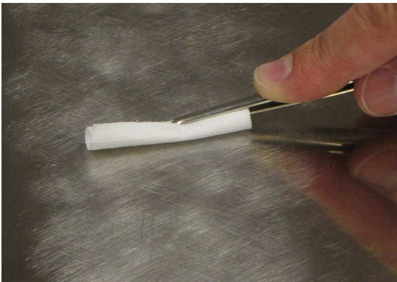
Abb. 1.4: Reinigung der aufgerauten Installationsfläche
