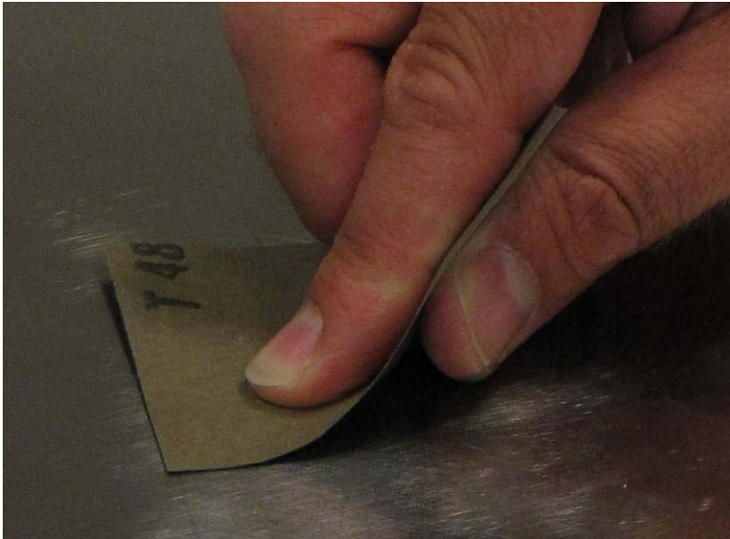
Abb. 1.3: Aufrauen der Oberfläche des Messkörpers
